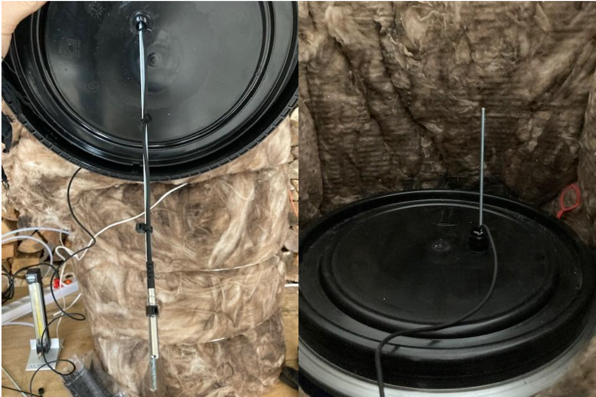
Temperatursensor monteret på jernstang, der via hul i låget kan stikkes ned i tønden.
