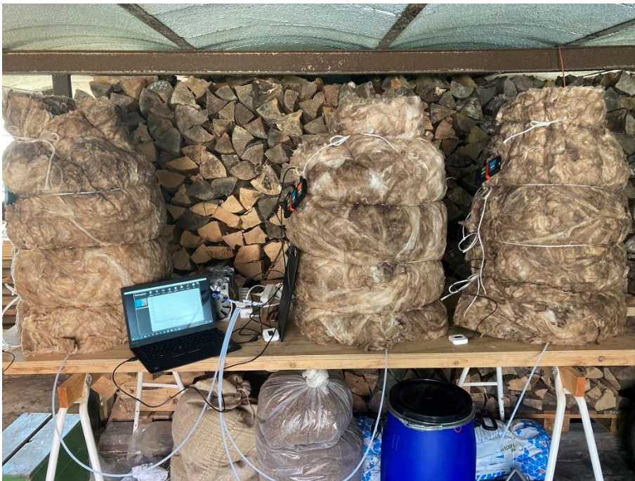
Forsøgsopstilling med komposteringsforsøg med frass og pileflis, startet 28/5 2021. Efter montering af isoleringsmateriale og med aflæsning af CO 2 -koncentration.
