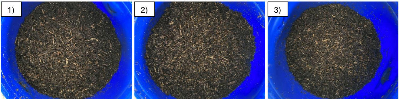
Tønder med færdige blandinger af frass og pileflis i forskellige blandingsforhold med tilstræbt C/N-forhold på hhv. 20 (1), 25 (2) og 30 (3). Der var hhv. ca. 50, 50 og 45 L biomasse i de tre tønder.
