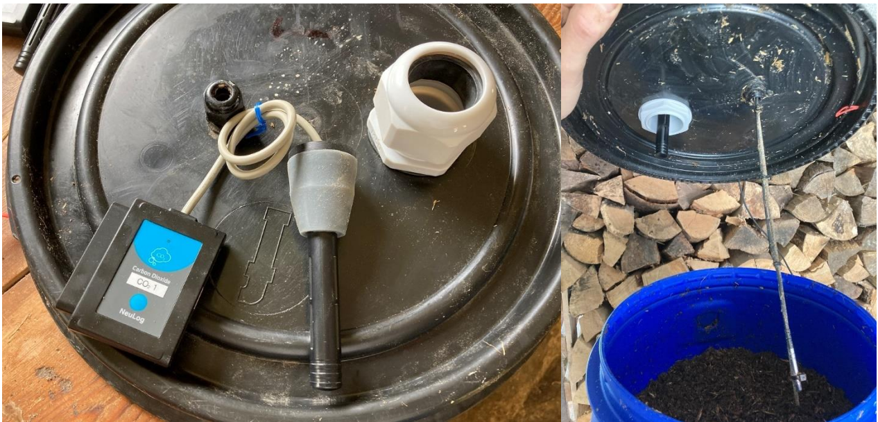
CO 2 -sensor monteret i låget i tønden. T.h. ses både CO 2 -sensor og temperatursensor.
