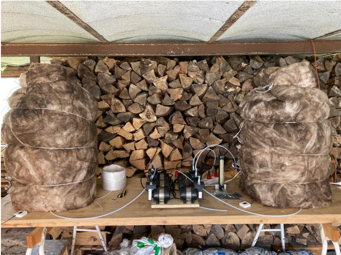
Forsøgsopstilling med to tønder med mulighed for indblæsning af luft i bunden, isolering for at begrænse varmetab, og løbende måling af temperaturen midt i tønden.
